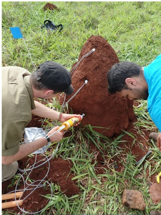
FIGURE 2.4 – Installation des enregistreurs de température et d'hygrométrie dans les nids lors de la deuxième campagne de suivi des nids de C. cumulans et P. araujoï . (A) Schéma de l'emplacement des sondes dans le nid et dans le sol adjacent. (B) Percement d'un nid de P. araujoï dans le but d'y installer les tubes dans lequel les sondes sont glissées. (C) Occlusion des tubes contenant les sondes avec du silicone. Le nid présenté sur cette photo est un nid de C. cumulans . (D) Détail du dispositif d'enregistrement mis au point par Patrick Arrufat au laboratoire. Photographies par Rémi Gouttefarde
