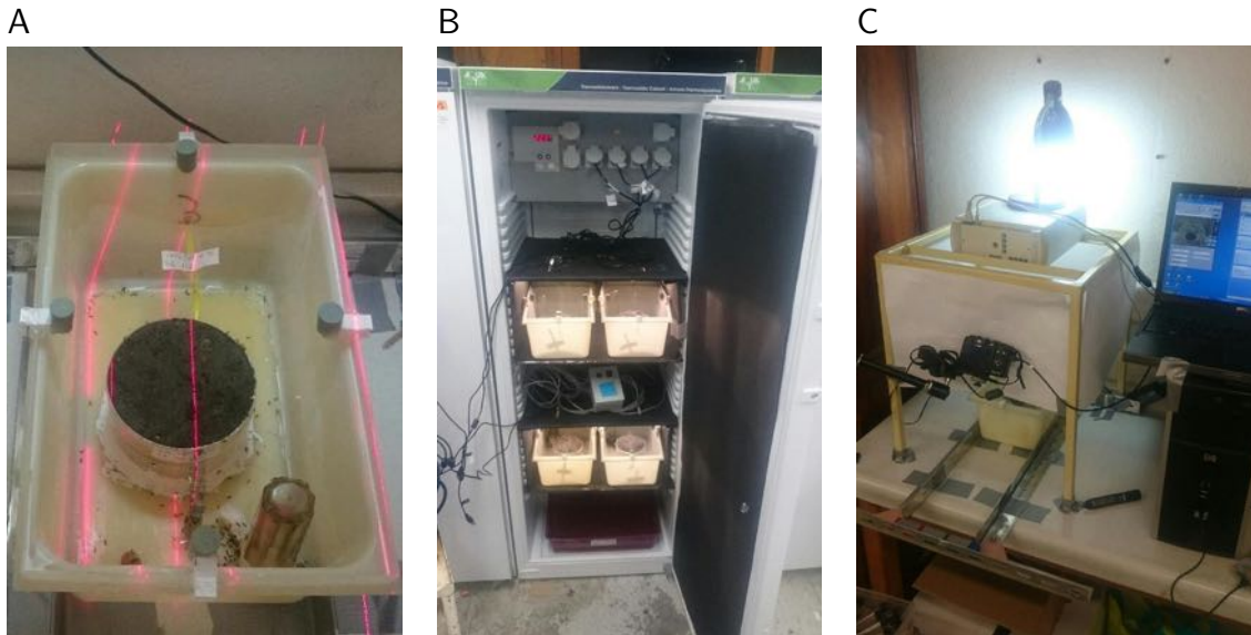
FIGURE 5.4 – Dispositif utilisé dans la pré-expérience de construction (dispositif « libre accès »). (A) Dispositif expérimental lors d'un scan. (B) 4 dispositifs placés dans une des 3 étuves. (C) Ensemble du dispositif d'acquisition (avec le scanner de surface sur le dessus).
