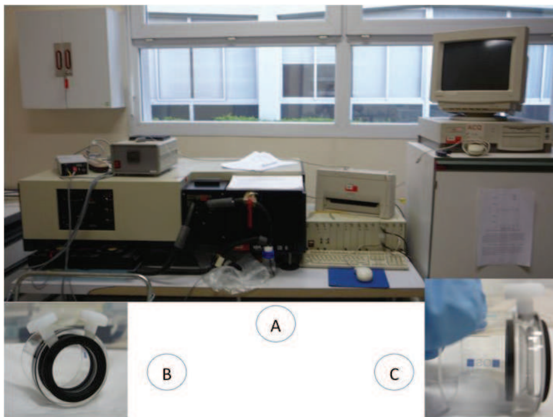
Figure 44 : (A) Dichrographe CD6 Jobin-Yvon et sa cellule en quartz. (B) vue de face et profil (C).
