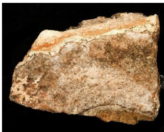
Figure 2. Échantillon de calamine extrait au Missouri, constitué d'hémimorphite ( \text{Zn}_4\text{Si}_2\text{O}_7(\text{OH})_2 \cdot (\text{H}_2\text{O}) ) et de smithsonite ( \text{ZnCO}_3 ) (Rob Lavinsky, 2010).
