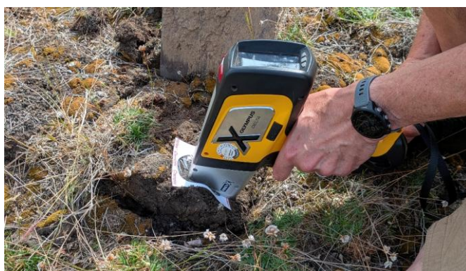
Figure 15. Pistolet XRF (DS-6000 Delta, Olympus) utilisé sur un échantillon de sol superficiel.
