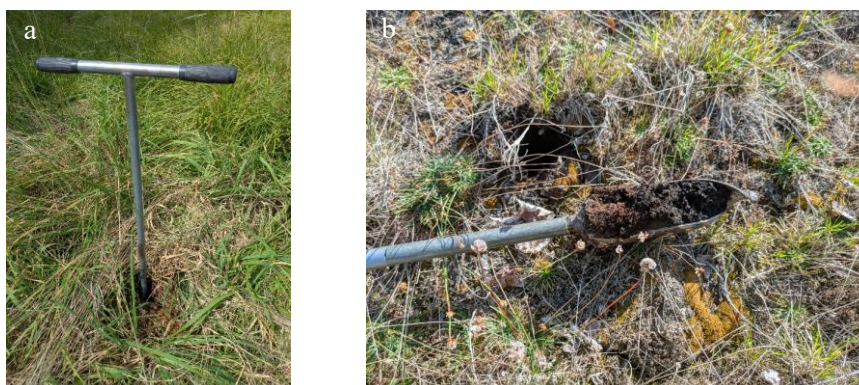
Figure 13. a. Tarière pédologique plantée dans le sol. b. Carotte de sol extraite par la tarière.
